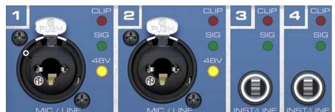
図3. XLRコンボジャック(#1, 2)とTRSジャック(#3, 4)を示したRME Fireface UCオーディオインターフェースの全面パネル
