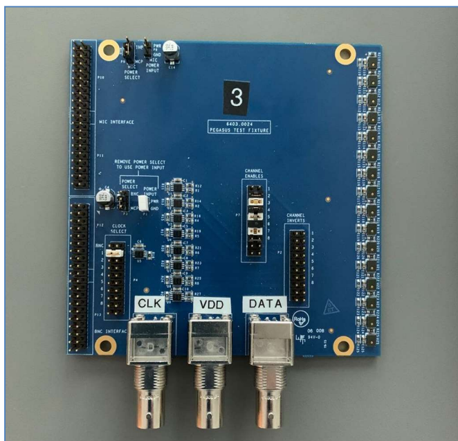
図3. 16マイクロフォンアレイを搭載したPDM 16テスト設備
