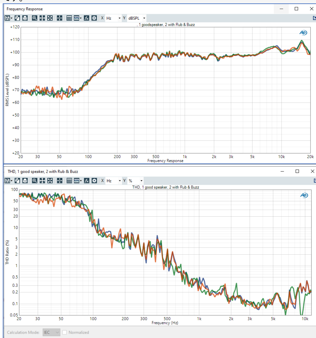
図 2. 3 つのドライバー (問題ないユニット 1 式と Rub and buzz 歪みが見られるユニット 2 式) の周波数応答 (上部) と THD 応答 (下部) のグラフ
