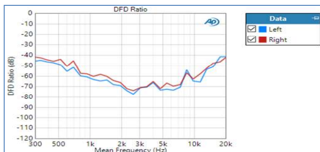
図24. ヘッドフォンのDFD Ratio (d2+d3)-周波数応答
