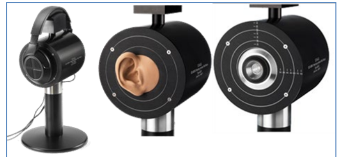
図2. GRAS 45CA ヘッドホンテストフィクスチャー
